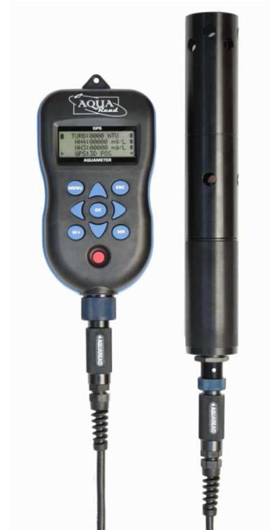
Das Aquameter Handgerät ist mit einem GPS Empfänger ausgestattet so dass die Messdaten mit den zugehörigen geographischen Koordinaten Längen- und Breitengrad sowie Höhe über NN abgespeichert werden.
