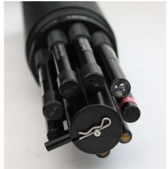
Die erneute Kalibrierung aller Sensoren ist sehr einfach und bei einem regelmäßigen Einsatz im Feld mit der Kalibrierlösung RAPIDCAL™ in einem Schritt möglich. Ein vollständiges Kalibrieren der einzelnen Sonden ist in einzelnen unkomplizierten Menüschritten nach den Anweisungen auf dem AQUAMETER™ durchführbar.
